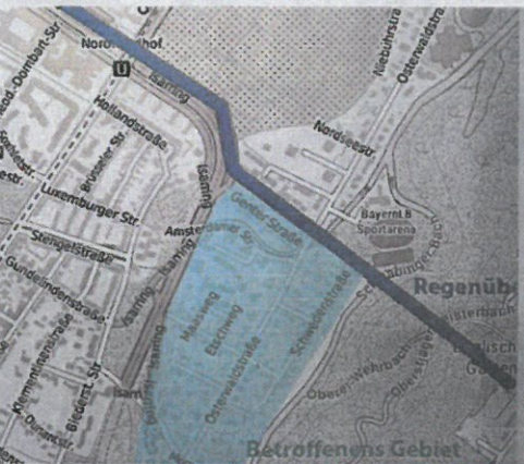
Der Regenwasserkanal der MSE (dunkelblau) und das von der Nässe betroffene Gebiet zwischen Isarring und Schwedenstraße (hellblaue Fläche).
